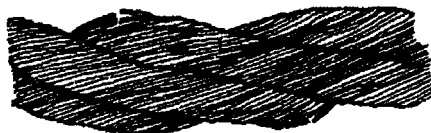
Рисунок 1. Обрывы и смещения проволок каната крестовой свивки
