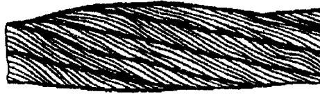
Рисунок 13. Местное увеличение диаметра каната
